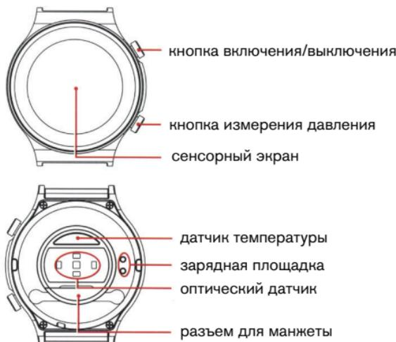
На обратной стороне корпуса расположены зарядная площадка, оптический сенсор, датчик температуры и разъем для крепления пневматической манжеты.
